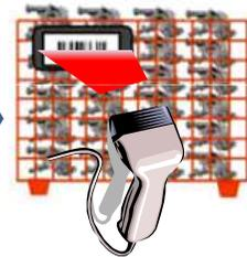
②熱処理工程前に自動読取。適切な炉に自動搬送することも可能。
